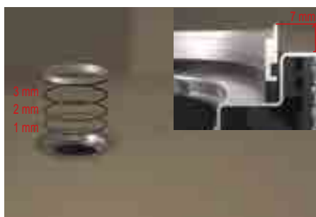
11. Ha az alkalmazott műgyanta burkolat 1-7mm között lesz, a mellékelt további alátét gyűrűvel 1mm-es lépésközökkel beállítható a kívánt burkolat magasság a képen látható módon.
